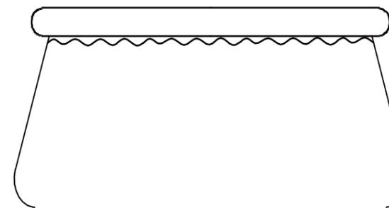
1. Certifique-se de que a ligação de drenagem está colocada corretamente e que a tampa está apertada. Comece a encher a piscina com água. Depois de encher com cerca de 2,5 cm de água, pare de encher e alise as irregularidades no fundo da piscina. Puxe a superfície exterior a partir da extremidade superior a toda a volta da piscina para que esta encha regularmente.
